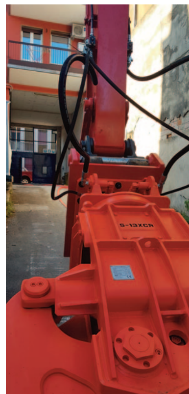
NPK S-13XCR Sul nuovo Hitachi Manfreda Scavi ha montato un nuovo pinza NPK da 1.485 kg e 1.750 kN di forza.
